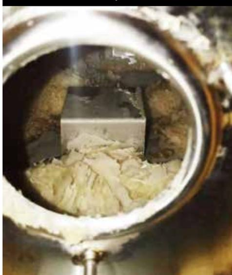
Le calcaire était présent sous forme de flocons qui ne pouvaient pas être évacués par le trou d'évacuation du cuiseur-vapeur. Pour tester l'efficacité de Vulcan, aucune opération d'entretien n'a été entreprise avant l'installation de Vulcan S10.
