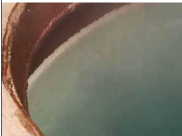
Avant l'installation de Vulcan, le réservoir d'eau chaude était recouvert de calcaire dur, très difficile à éliminer.
