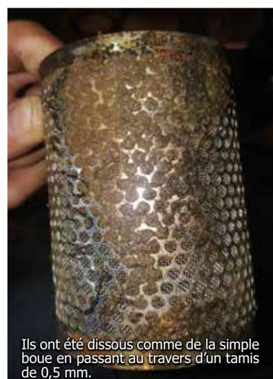
Ils ont été dissous comme de la simple boue en passant au travers d'un tamis de 0,5 mm.
